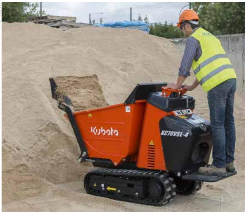
**Le mini-transporteur KC70VSL-4 sur chenille de Kubota est pourvu d'une pelle auto-chargeuse et d'une voie variable. Stable et puissant, il se caractérise par une capacité de chargement de 700 kg et un refroidisseur d'huile hydraulique.**
