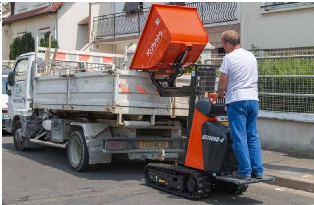
Grâce à son système de déversement en hauteur, le KC70VHD-4 de Kubota peut vider son chargement jusqu'à une hauteur de 1,43 m (au niveau des axes). De plus, sa portée de 447 mm lui permet de déverser aisément les matériaux au-delà du bord de la ridelle d'un camion.
