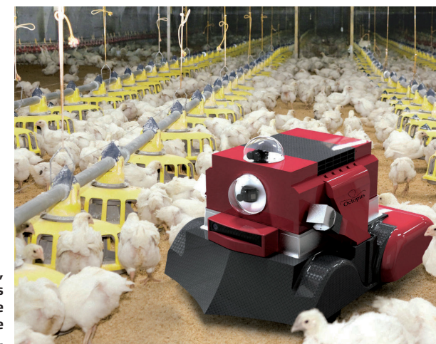
Octopus, créé par Octopus Robots, surveille et désinfecte les poulaillers.
