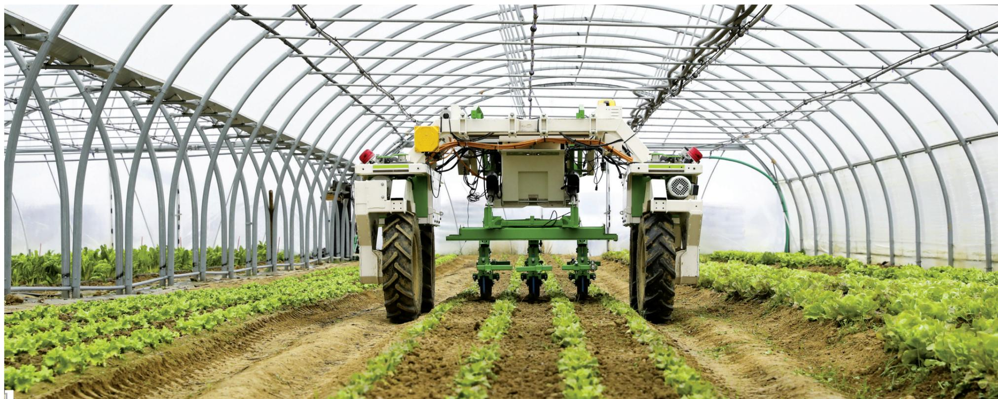
1. Dino, le deuxième robot de désherbage mécanique de Naïo Technologies, s'adresse au maraîchage industriel. 2. Un tiers des 30 salariés de la start-up sont des développeurs. 3. L'assemblage des robots est réalisé à la main. 4. L'atelier situé à Escalquens sert aussi à la maintenance. 5. Environ 100 robots Naïo sont en circulation.
