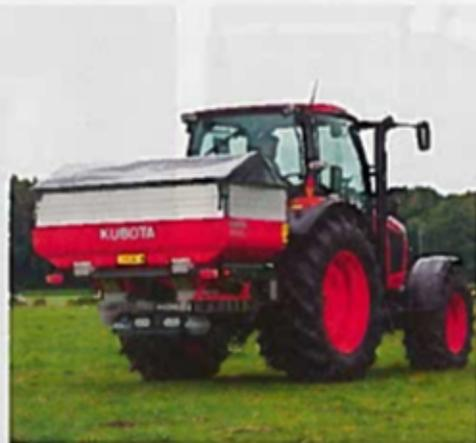
**Entraînement.** Kubota a développé une plate-forme e-Power. Installée à l'arrière d'un tracteur classique, elle délivre 10,5 kW pour entraîner, par exemple, les disques d'un épandeur modifié. KUBOTA
