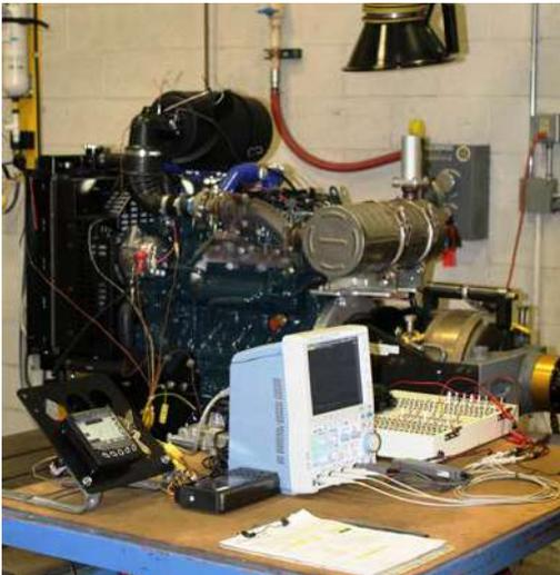
◀ Dynamomètre et matériel de test branchés à un groupe moteur V2403-CR-TI-E4B.
