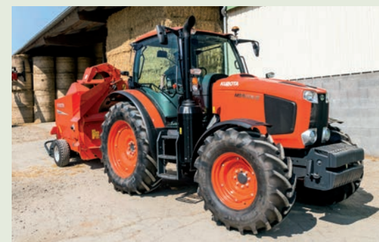
Le tracteur est équipé d'un système de demi-tour rapide Bi-Speed. Dès que l'angle de braquage dépasse 35°, la vitesse des roues avant augmente afin d'obtenir un rayon de braquage plus court.
