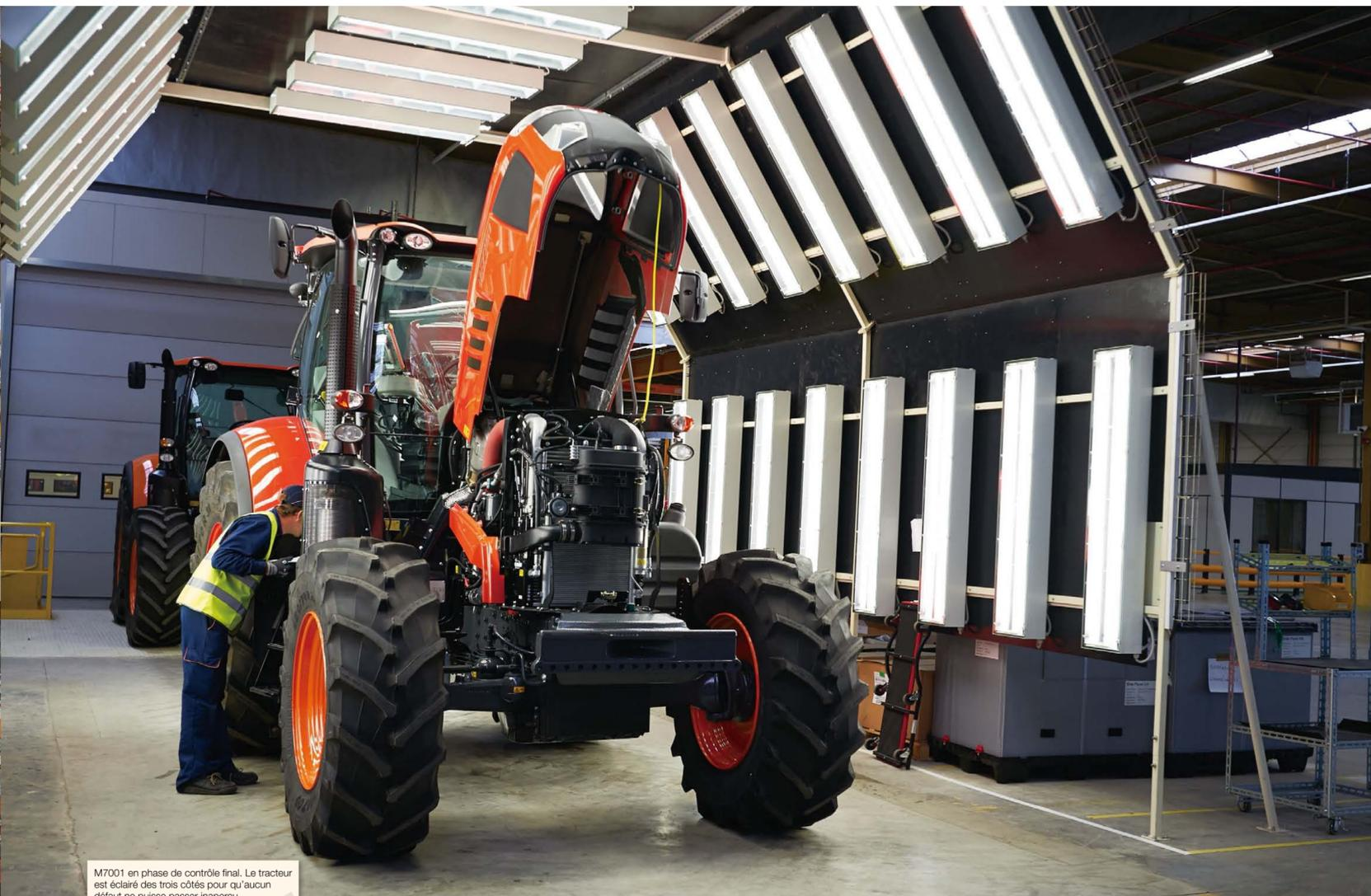
M7001 en phase de contrôle final. Le tracteur est éclairé des trois côtés pour qu'aucun défaut ne puisse passer inaperçu.
