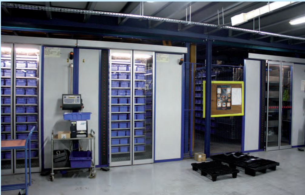
Six carrousels verticaux sont utilisés pour le stockage des petites pièces. Pour chaque opération de picking, un système de voyants lumineux indique l'emplacement des bacs où doit être réalisé le prélèvement.
