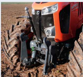
Le relevage avant Zuidberg lève jusqu'à 3,5 t et bénéficiera prochainement de commandes extérieures.
