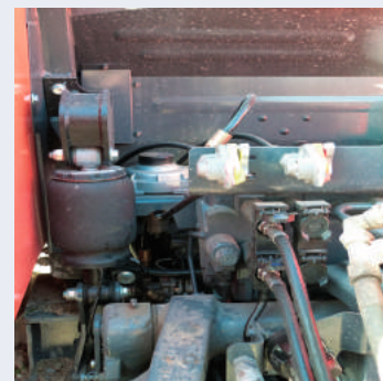
La version Activ intègre de série une suspension de cabine à deux poumons pneumatiques.
