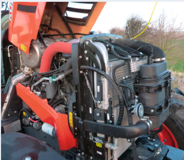
Le quatre-cylindres Kubota de 6,1 L intègre un filtre à particules suivi d'un dispositif d'injection d'AdBlue SCR.
