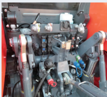
Le pont arrière, d'origine ZF, intègre un relevage de 9,2 t de capacité et jusqu'à six distributeurs à double effet.
