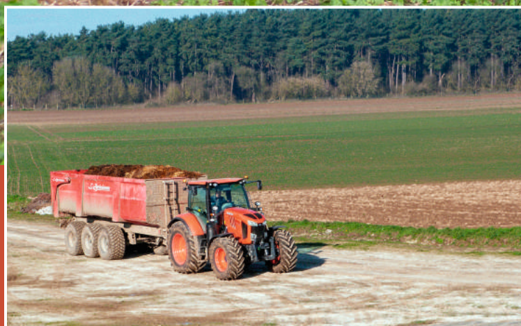
La suspension pneumatique de la cabine et celle du pont avant, qui est hydraulique, ont été mises à rude épreuve sur les routes et les chemins dégradés des environs.
