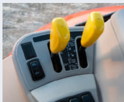
Kubota propose, de série, les régimes de prise de force de 540, 540 Eco, 1000 et 1000 Eco tr/min.
