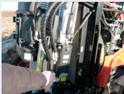
L'intercooler, l'échangeur d'huile hydraulique, le refroidisseur de carburant et le condenseur de climatisation basculent légèrement pour faciliter le nettoyage.
