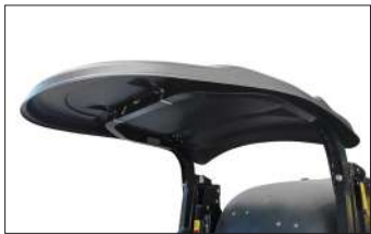
Optionele afdak Deze optie biedt de bestuurder bescherming tegen alle weersomstandigheden en verbetert het algehele comfort tijdens lange diensten
