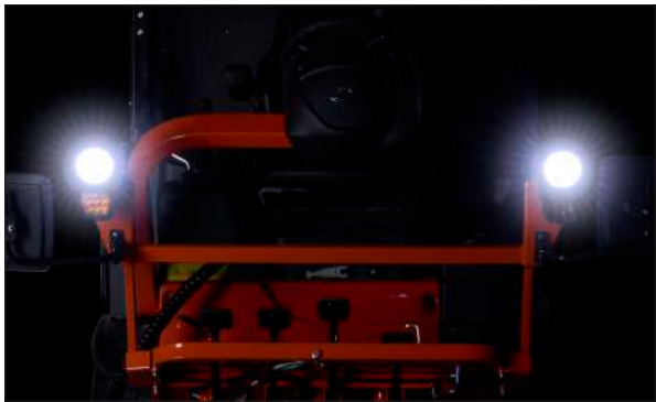
Ledverlichting Geïntegreerde ledkoplampen en zwaailichten verbeteren de zichtbaarheid en veiligheid bij werkzaamheden bij weinig licht, terwijl het energieverbruik laag blijft.
