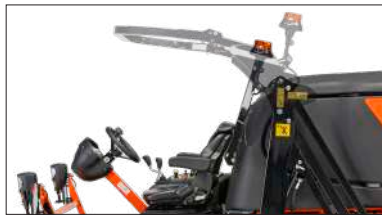
Veiligheidsbeugel (ROPS) Het opklapbare ontwerp biedt uitstekende bescherming terwijl de toegang voor opslag en reparaties eenvoudig blijft.
