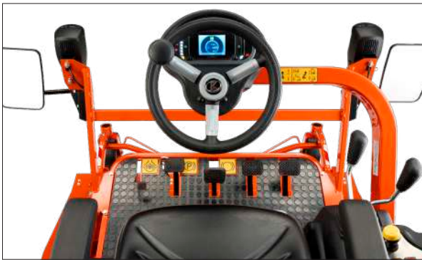
Ergonomisch ontwerp Een lagere zitpositie in combinatie met een ruim, kantelbaar platform verbetert het zicht en vermindert vermoeidheid bij langdurig gebruik. Het moderne kleurendisplay toont real-time informatie.
