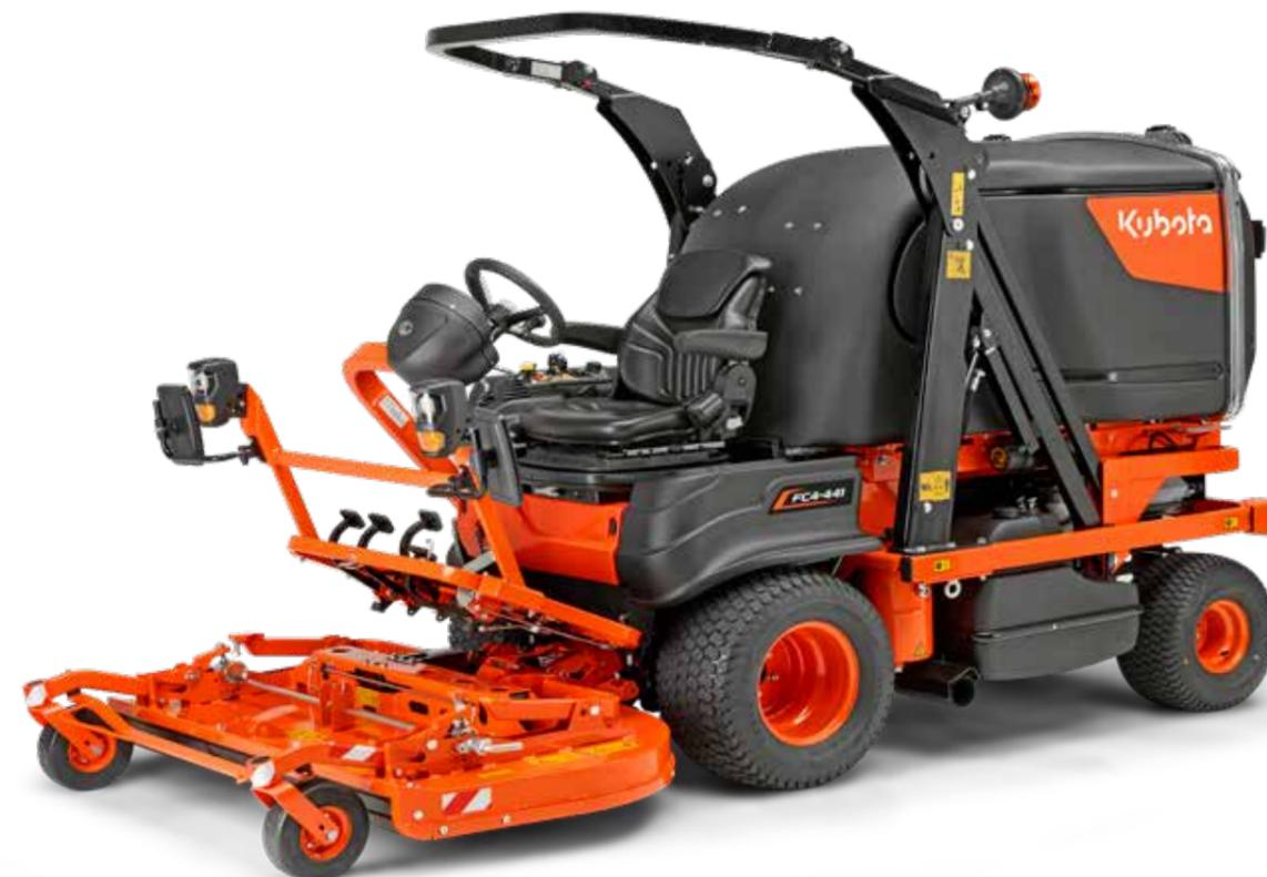
Le plateau de coupe rotatif, d'une largeur de 150 cm, intègre une technologie à double lame à rotation inversée, garantissant une coupe uniforme sur de grandes surfaces et un résultat impeccable à chaque fois.
