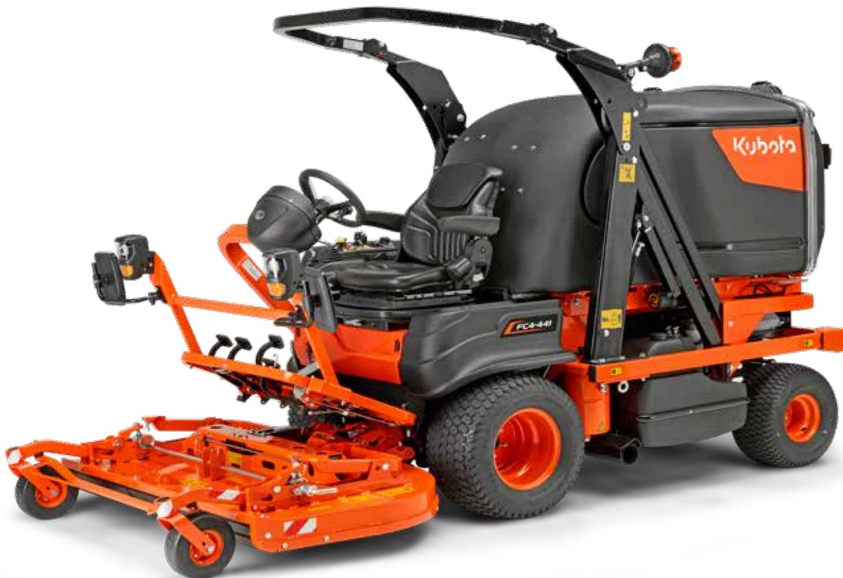
Le plateau de coupe rotatif, d'une largeur de 150 cm, intègre une technologie à double lame à rotation inversée, garantissant une coupe uniforme sur de grandes surfaces et un résultat impeccable à chaque fois.
