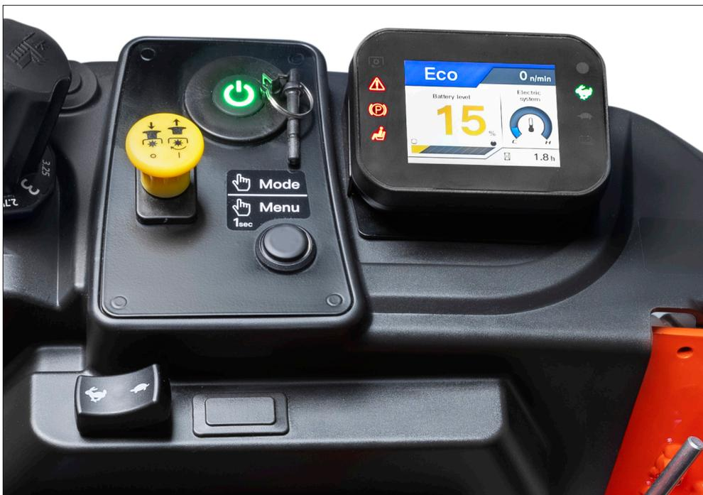
L'affichage des compteurs est incorporé dans la console de droite. Le panneau d'affichage vous permet de connaître l'état actuel de la batterie en ce qui concerne les niveaux de décharge. Il intègre également un affichage de diagnostic des codes d'erreur, qui permet de détecter rapidement et facilement toute anomalie éventuelle. Les capteurs assurent la sécurité et la protection des machines en surveillant en permanence les performances de Ze.
