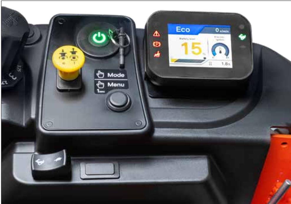
All'interno della console di destra si trova il pannello dei contatori. Questo pannello consente di conoscere lo stato attuale della batteria per quanto riguarda i livelli di carica. Il pannello è inoltre dotato di un display diagnostico dei codici di errore che consente di riconoscere rapidamente e facilmente eventuali guasti. I sensori garantiscono la sicurezza e la protezione della macchina monitorando costantemente le prestazioni di Ze.
