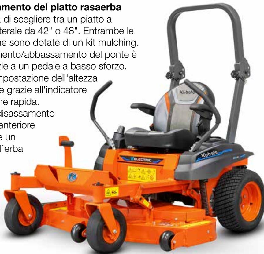
La Serie Ze offre i vantaggi della batteria con prestazioni pari a quelle di un tosaerba a benzina.
