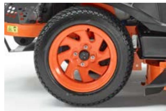
**Excellente répartition du poids** Les pneus à profil bas n'endommagent pas le gazon et ne le compactent pas. Les jantes ajoutent une allure élégante à la Z2-481.
