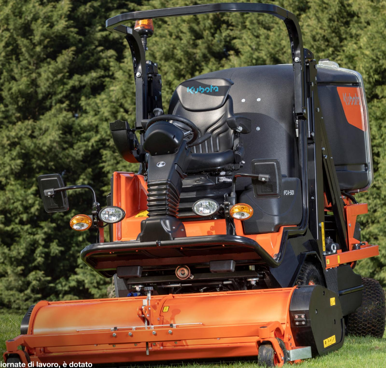
Progettato e costruito per affrontare lunghe giornate di lavoro, è dotato di serie di un sedile con molleggio pneumatico super comfort deluxe. I supporti antivibranti e l'ampia pedana ne migliorano ulteriormente il comfort.
