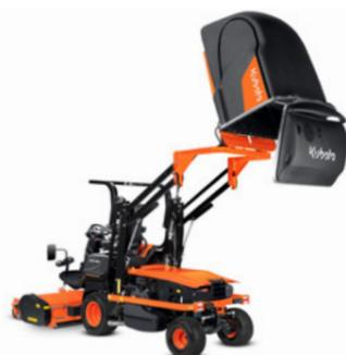
conducente ed i presenti. Un sistema a parallelogramma azionato idraulicamente e un'elevata distanza di ribaltamento consentono uno scarico efficace e sicuro.
