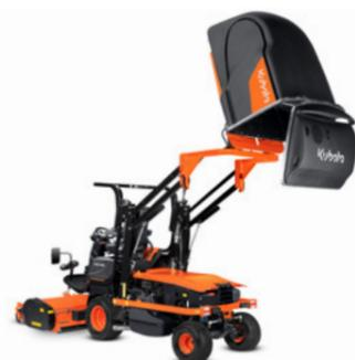
est totalement sans danger pour le conducteur et les passants. Un système de levage/descente à parallélogramme à commande hydraulique et un bon dégagement de basculement en porte-à-faux permettent un déchargement efficace et sûr.
