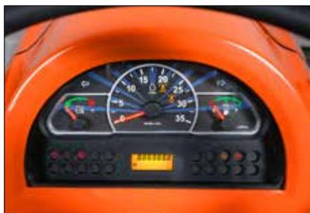
Un capteur sur le tableau de bord indique quand le filtre à air doit être nettoyé, simplifiant ainsi l'entretien.
