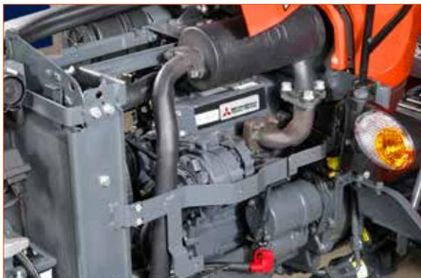
Les puissants moteurs diesel Mitsubishi Stage V trois cylindres - disponibles en 22 chevaux ou 25 chevaux - bénéficient d'un refroidissement par eau. Leur architecture 4-temps, associée à une injection en chambre de turbulence, puise l'air via un filtre performant, assurant ainsi efficacité et durabilité.
