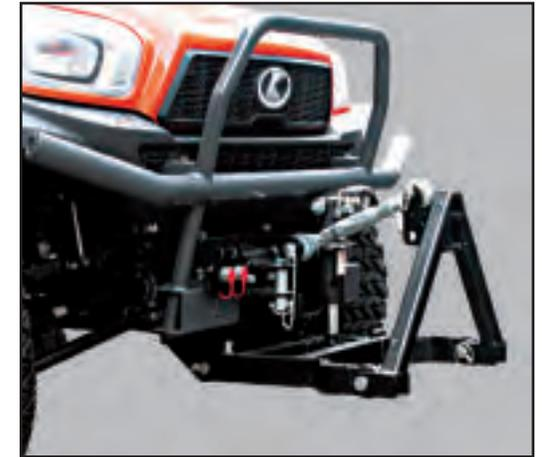
■ Hydraulischer Frontkraftheber
