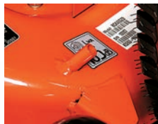
Orifice de raccordement d'un tuyau d'eau pour le nettoyage du plateau.
