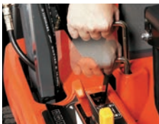
Pour nettoyer l'arrière du conduit.
