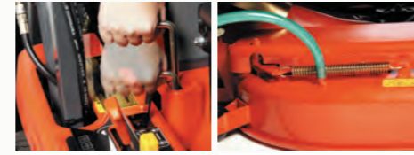
Reiniging van het achterste deel van het kanaal. Aansluiting voor een waterslang voor het reinigen van de maaier.
