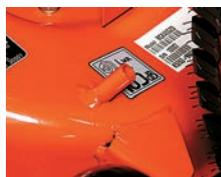
Orifice de raccordement d'un tuyau d'eau pour le nettoyage du plateau.
