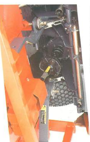
Embrayage de prise en force et relevage de la hauteur à commande hydraulique.
