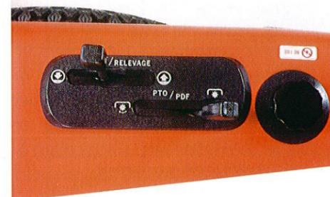
Frizione della presa di forza e regolazione dell'altezza tramite un comando idraulico.
