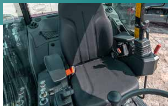
Siège confort à suspension pneumatique avec chauffage
