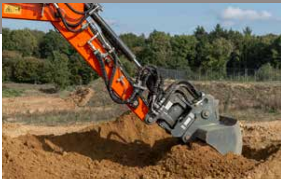
Hydraulischer Schnellwechsler HS08 mit Schwenkeinheit
