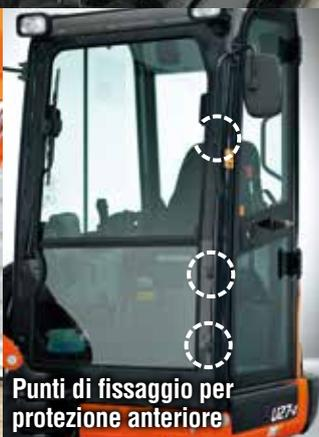
Punti di fissaggio per protezione anteriore
