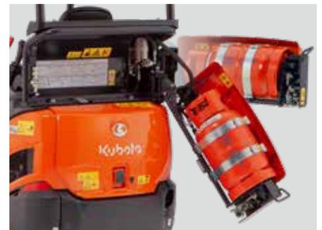
A seconda della tipologia di lavoro, un serbatoio GPL può durare un'intera giornata lavorativa. A differenza del gasolio, il GPL non può fuoriuscire e contaminare l'ambiente circostante. Una struttura rigida protegge il serbatoio dalla luce solare diretta e da eventuali impatti.
