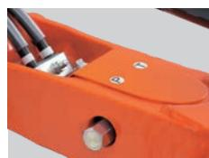
Serienmäßig sind der K008-5 und U10-5 mit einem hydraulischen Zusatzsteuerkreis ausgestattet, d. h. die Hydraulikleitungsverlegung bis Auslegerende gehören zum Lieferumfang der Maschine. Zur Reduzierung von möglichen Beschädigungen wurden die Leitungen des Zusatzhydraulikkreis im Ausleger geschützt integriert.
