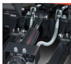
Die Planierschildzylinder-Hydraulikschläüche sind zweiteilig ausgeführt. Für den Fall der Fälle können die Hydraulikschläüche so problemlos und schnell vor Ort ausgewechselt werden.
