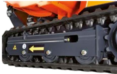
Die Short-Pitched-Raupenbänder aus Gummi werden mit einem Fettzylinder gespannt. Dank dieser Funktion bewahren die Raupenbänder eine gewisse Nachgiebigkeit für den Fall, dass Material unter das Raupenband gelangt. Die kurze Teilung des Raupenbands verringert Schwingungen und erhöhte somit den Benutzerkomfort.
