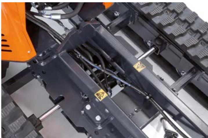
Diese Art von Unterwagen ermöglicht eine Verringerung der Maschinenbreite auf 758 mm (Standardausführungen) bzw. eine Verbreiterung auf 1058 mm für eine erhöhte Standsicherheit.
