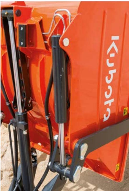
Die Selbstladeschaufel wird über zwei Zylinder betätigt, die sich unter der Mulde befinden. Aufgrund ihrer Lage sind sie gut geschützt und verfügen über ein großes Hubvermögen.
