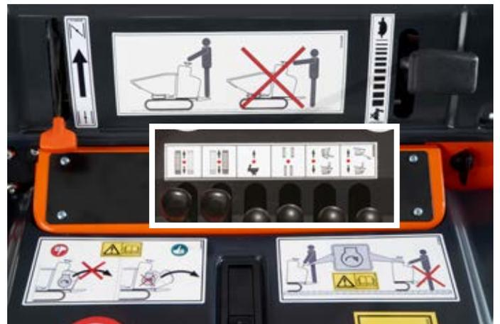
Vom Fahrerposten aus gut sichtbar. Die Sicherheitsaufkleber dienen dem schnellen und leichten Verständnis der Funktionsweise des Geräts. Dies erhöht Sicherheit und Produktivität. Selbst ein gelegentlicher Benutzer versteht sofort, wie er die Maschine zu bedienen hat.
