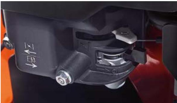
Der Kraftstofftank ist mit einem Absperrventil versehen. Bei Bedarf kann der Starter manuell betätigt werden (Benzinausführung).
