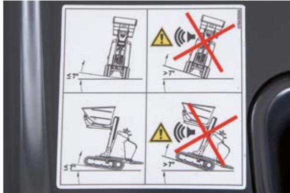
Steht das Gerät mit hochgefahrener Mulde an einem Hang mit einer Neigung von über 8° (an beiden Achsen), ertönt ein akustisches Warnsignal.
