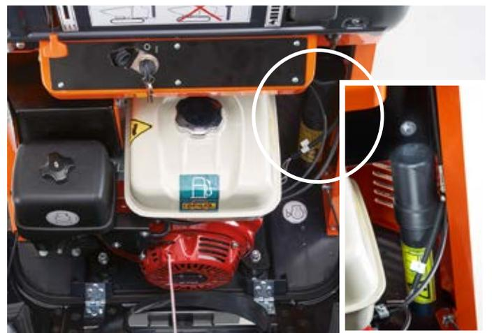
Eine wasserdichte Dokumentenbox schützt die Benutzerhandbücher im verriegelten Motorfach. So hat der Fahrer die Unterlagen der Maschine immer griffbereit.
