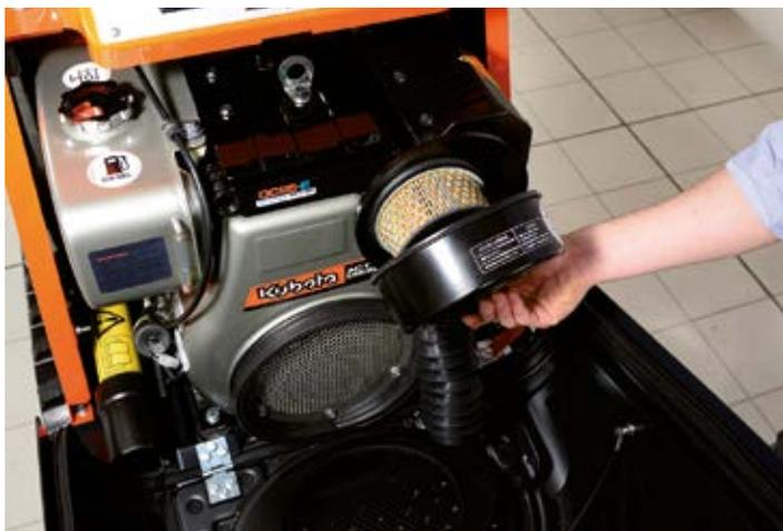
Der Motorhaube kann weit geöffnet werden, so dass alle wartungsrelevanten Komponenten, wie z.B. Kraftstofftank, Luftfilter, Motorölstandanzeiger und die Batterie, bequem zugänglich sind.
