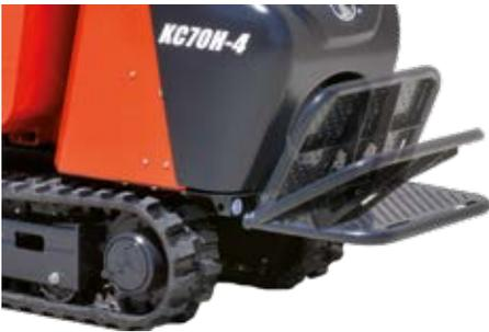
Der KC70-4 ist mit einem einklappbaren Trittbrett ausgestattet. Wenn das Trittbrett ausgeklappt ist, kann der Benutzer sicher aufrecht auf der Maschine arbeiten. Ist die Trittstufe eingeklappt, verkürzt sich die Gesamtlänge um 214 mm und spart so Platz beim Transport und der Lagerung. Das Trittbrett ermöglicht dem Fahrer ein schnelles Auf- und Absteigen.
