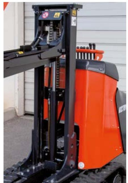
Der Teleskopmast des KC70VHD-4 hebt die Last vertikal an und sorgt für eine ausgezeichnete Standsicherheit.
