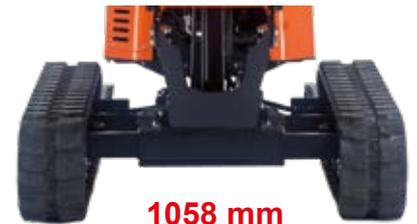
Die veränderliche Spur ermöglicht die Erweiterung des Raupenabstands von 758 bis 1058 mm. Steht der KC70-4 auf Mindestbreite, passt er problemlos durch eine Standard-Tür. Steht der KC70-4 auf maximaler Breite, bietet er in jeder Situation eine hohe Stabilität.
