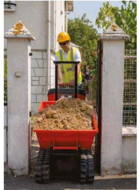
Wie auch alle anderen Modelle sind die KC70HD/VHD-4 besonders für Baustellen in beengten Bereichen geeignet. Der verstellbare Rahmen ermöglicht das Passieren schmaler Stellen (758 mm) und gewährleistet eine ausgezeichnete Stabilität bei breiter Spureinstellung (1058 mm).
