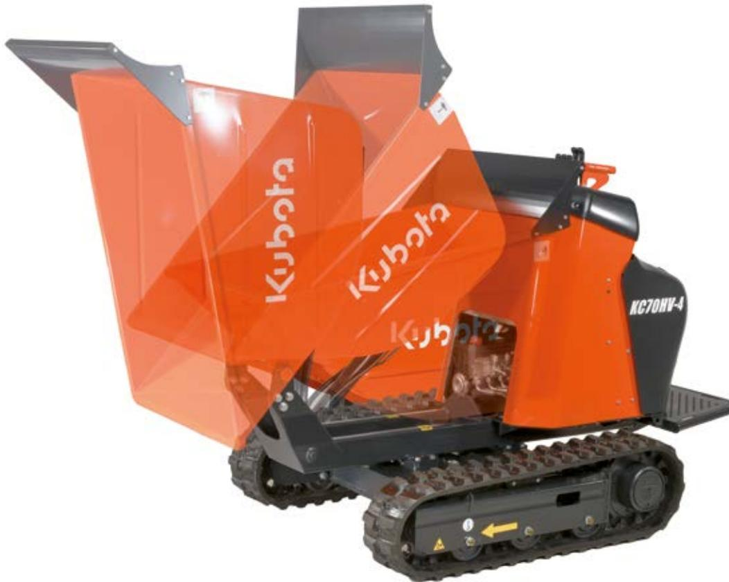
Die Entladevorgänge gehen schnell und einfach von statten. Die Lademulde wurde so konzipiert, dass das Material schnell abgekippt wird. Mit einem Kippwinkel von 88° (85° bei den Ausführungen HD/VHD) rutscht das Material problemlos aus der Lademulde.
