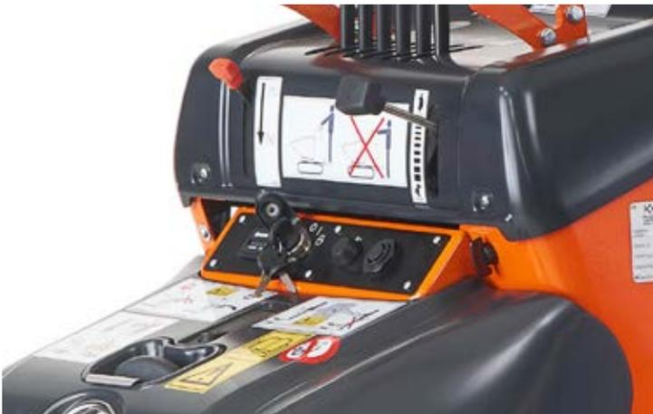
Die Dieselausführungen sowie die Benzinmotorausführungen HD und VHD sind mit elektronischer Zündung ausgestattet. Alle anderen Benzinausführungen haben ein robustes Starterseil, das vom Fahrersitz aus gezogen wird. Es sorgt in Kombination mit dem automatischen mechanischen Dekompressionssystem für einen leichten Handstart in jeder Situation.
