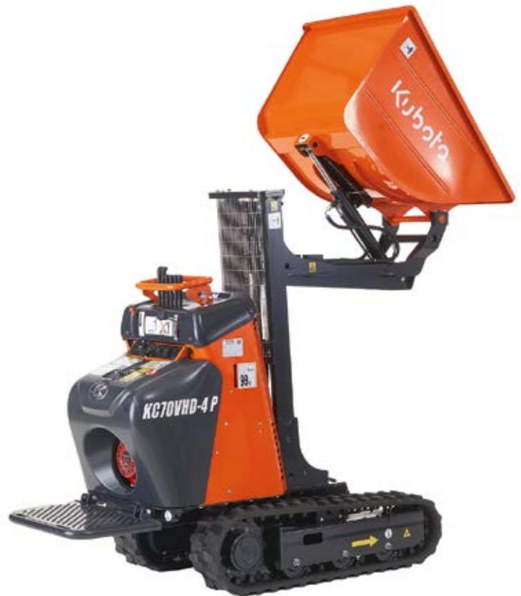
Das teleskopische Hubsystem der Ausführungen HD und VHD gewährleistet bei der Entladung maximale Stabilität.
