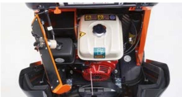
Die Konsole der Benzinmotorausführung kann zur Befüllung des Tanks geöffnet werden. Auch bei der Dieselausführung ist die Betankung einfach.
