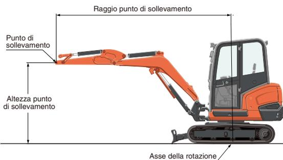
\* Le prestazioni fornite sono quelle rilevate con una benna standard Kubota e senza attacco rapido.
