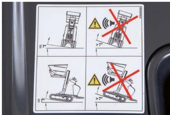
Se la macchina si trova in una pendenza (funziona sui due assi) superiore a 8° e il cassone è sollevato, un allarme vi avverte della situazione di pericolo.
