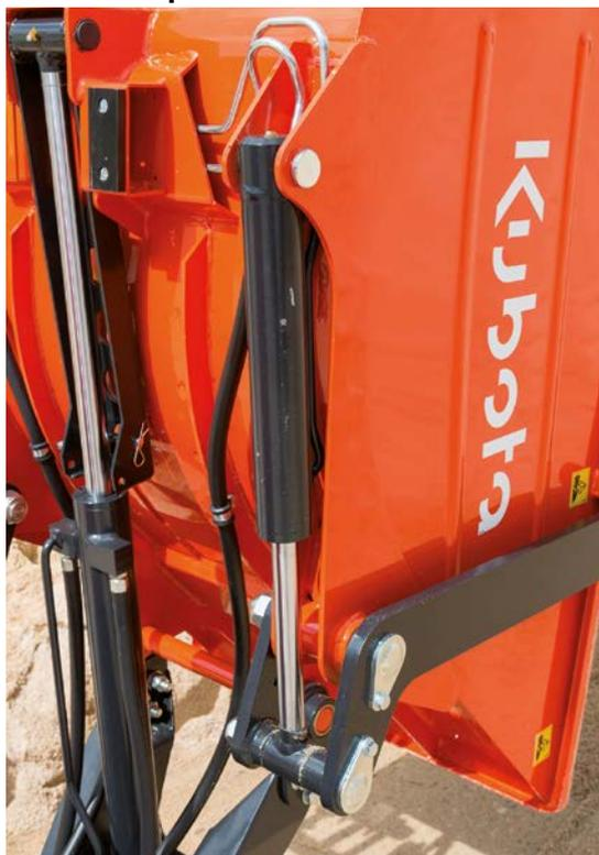
La pala di carico è azionata da due cilindri idraulici situati sotto il cassone. Grazie alla loro posizione, sono ben protetti e assicurano una buona capacità di sollevamento.
