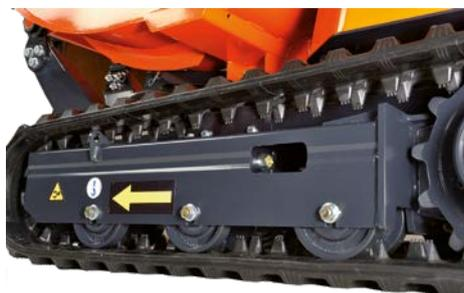
I cingoli di gomma sono mantenuti tesi dal sistema tendi cingolo a grasso. Questo sistema consente l'ammortizzazione quando del materiale entra nella cingolatura evitando lo scingolamento. Inoltre, il passo corto del cingolo genera meno vibrazioni per una guida più fluida e un maggiore comfort per l'operatore.
