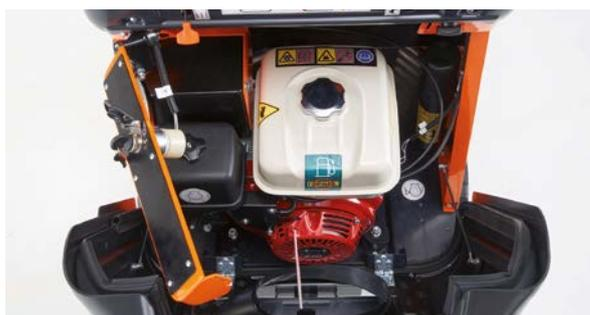
La consolle della versione a benzina si apre per un più facile rifornimento del serbatoio. Nella versione diesel, l'operazione è altrettanto facile da realizzare.
