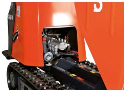
I dumper cingolati KC70-4 sono dotati di una trasmissione idraulica. Questa trasmissione avanzata offre un controllo regolare, l'operatore può selezionare la velocità più adatta al terreno e può facilmente passare dai 3,3 km/h della seconda velocità su superfici piane ai 2,2 km/h della prima velocità su terreni più difficili. Questo sistema aiuta a rendere il lavoro più efficiente e produttivo, riducendo la manutenzione e anche il consumo di carburante.
