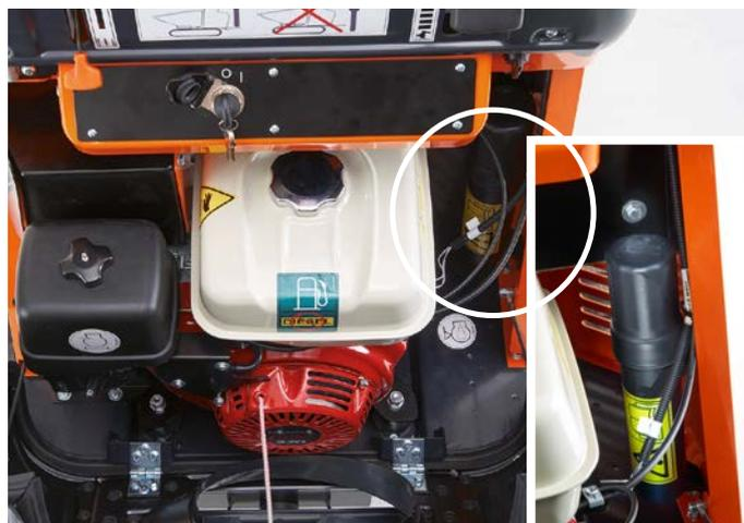
Porta documenti impermeabile per il manuale operatore che rimane protetto nel vano motore dotato di serratura. Ciò consente all'operatore di avere sempre a disposizione i documenti della macchina in tutta sicurezza.
