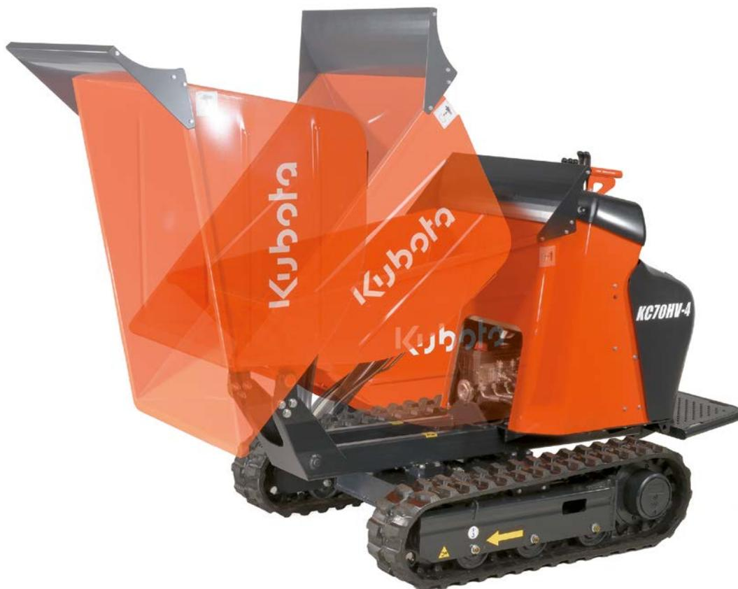
L'operazione di scarico è veloce e facile. Il profilo del cassone è stato progettato per garantire uno scarico rapido del materiale. Con un angolo di scarico di 88° (85° per versioni HD / VHD), tutti i materiali scivolano facilmente.
