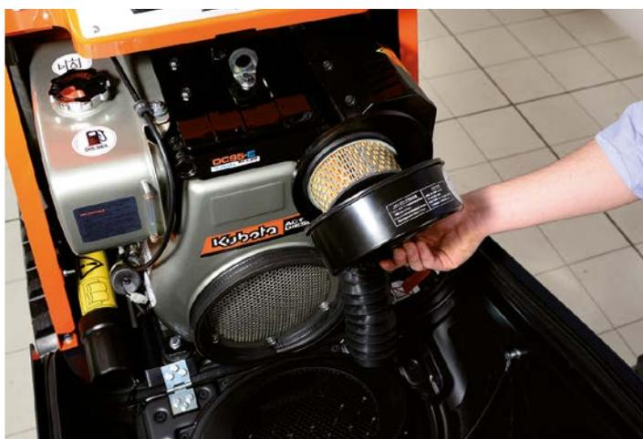
Un ampio cofano apribile, consente un facile accesso alle principali zone per la manutenzione quotidiana: serbatoio del carburante, filtro dell'aria, livello dell'olio motore, batteria e stacca batteria (quando presente) sono facilmente raggiungibili.
