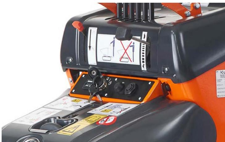
Tutte le versioni diesel e le versioni HD e VHD con motore a benzina sono dotate di avviamento elettrico. Tutte le altre versioni a benzina sono dotate di un'accensione a strappo per impieghi gravosi, questa è azionabile dalla posizione di guida. L'accensione manuale in combinazione con il sistema automatico di de-compressione, vi garantirà un facile avviamento in tutte le circostanze.
