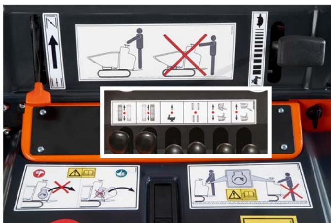
Facilmente visibili dalla posizione di guida gli adesivi di sicurezza offrono una comprensione rapida e semplice delle funzioni della macchina. Ciò aumenta la sicurezza e la produttività. Anche un operatore occasionale potrà facilmente comprendere come utilizzare la macchina.
