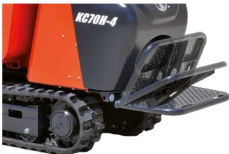
Il KC70-4 è dotato di una pedana richiudibile. Quando la pedana è abbassata, l'operatore può salirci in tutta sicurezza per muovere la macchina. Quando la pedana viene chiusa, la lunghezza complessiva viene ridotta di 214 mm questo permette di guadagnare spazio per il trasporto o lo stoccaggio. La posizione operativa in piedi facilita la salita e la discesa della macchina.
