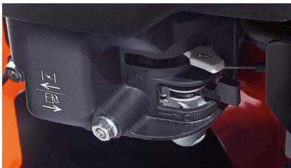
Il serbatoio del carburante è dotato di un rubinetto. Se necessario, l'aria dello starter può essere azionata manualmente (solo sulla versione benzina).
