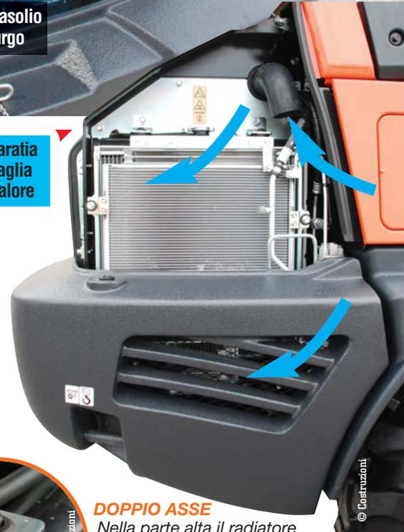
Radiatore refrigerante con scarico remoto sotto telaio
