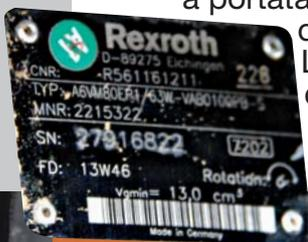
Il motore idraulico a pistoni assiali è un Bosch Rexroth a cilindrata variabile modello A6VM/63
