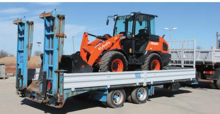
**6 PESI E 6 MISURE** La R085 è disponibile con cabina e tettuccio per pesi operativi di 4.790 e 4.565 kg. Lo stesso vale per la R065 (stesso telaio ma zavorra e powertrain diversi) che con cabina pesa 4.390 kg e con tettuccio 4.165. Quest'ultima, montando cerchi e pneumatici larghi, ha un peso intermedio ed è chiamata R065 Wide. Le larghezze ai pneumatici variano da 1.680 a 1.725 mm e le benne sono da 1.820 e 1.750 mm.
