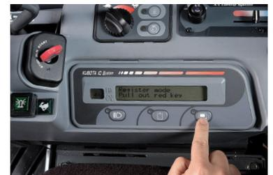
1 Insérez la clé Rouge d'enregistrement, puis pressez le bouton sur le tableau de bord.
