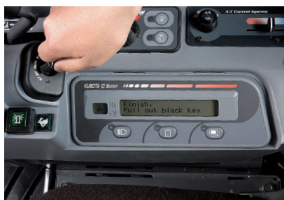
2 Insérez la nouvelle clé Noire "fonctionnelle".
