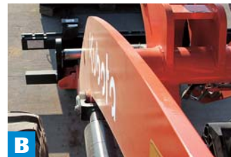
B Punto di accoppiamento dell' attacco rapido
