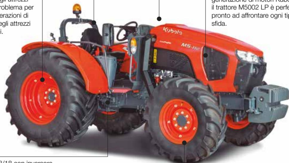
Il lavoro nei frutteti è più facile grazie al cofano in acciaio inclinato e ai parafanghi concepiti per minimizzare i danni alle colture. Il modello M5001 LP è un trattore dal design compatto ma comunque molto comodo ed efficiente. L'eccellente angolo di sterzata di 55° e l'esclusivo sistema "Bi-Speed" di Kubota conferiscono al trattore una manovrabilità senza pari.
