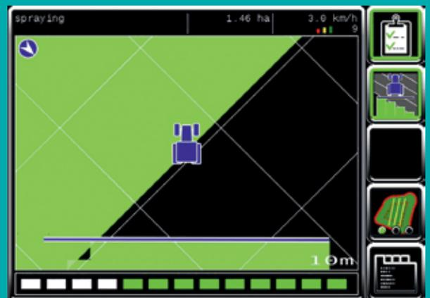
**Contrôle de section :** Désactive automatiquement les sections de votre outil de travail lorsqu'elles ne sont pas nécessaires, évitant ainsi les chevauchements et réduisant les coûts d'intrants.
