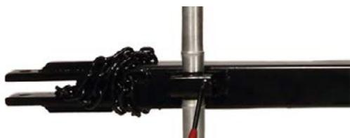
**Collegamento di accoppiamento di lunghezza regolabile (configurazione base)** Per 1.000, 1.500, 2.000, 3.000 lts
