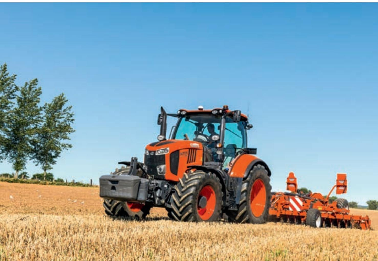
Avec une capacité de levage impressionnante de 9 000 kg, le M7001 vous permet de travailler rapidement avec des combinés de semis et d'autres outils lourds tels que des charrues, des déchaumeurs, etc. Le relevage avant d'une capacité de 3 500 kg offre
