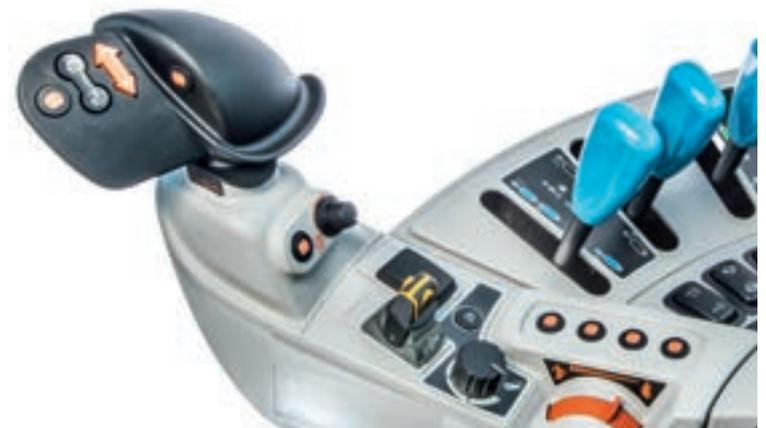
Dans tous les modèles du M7001, les commandes sont à portée de main. Sur le modèle standard toutes les commandes sont concentrées sur le côté droit ou sont placées avec le levier multifonction, tandis que les modèles haut de gamme sont équipés d'un accoudeur multifonction qui intègre toutes les commandes.
