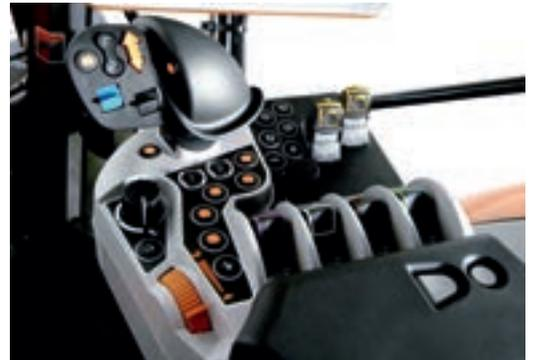
Les modèles Premium de la série M7001 sont équipés d'un circuit hydraulique à détection de charge à centre fermé, avec des débits variables qui peuvent simultanément s'acquitter de multiples fonctions, une pompe de 110 l/min indépendante avec quatre distributeurs à commande électronique. Jusqu'à deux distributeurs supplémentaires sont disponibles en option. Les clients qui ont besoin d'un contrôle de débit important sur leurs outils peuvent faire appel à la technologie Power-Beyond.
