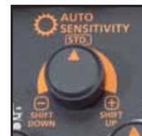
Potentiomètre de sensibilité d'Auto-Mode
