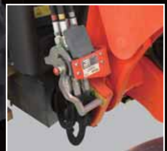
Coupleur hydraulique rapide à levier unique
